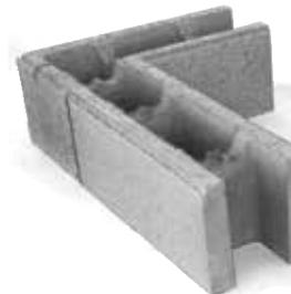
2. Forskalingsblokkene plasseres etter hverandre, ende mot ende. Det kan være en fordel å starte i et hjørne. Forskalingsmurens lengde avpasses med hele eller halve blokker. Skulle det trenges ytterligere tilpasninger, kan blokkene kappes med en vinkelsliper.
