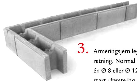
3. Armeringsjern legges i murens lengderetning. Normal armerings-mengde er én Ø 8 eller Ø 12 i hvert tredje lag, med start i første lag. Ved større sidebelastning kan forskalingsblokkene også armeres vertikalt. For påfølgende lag settes hjørneblokkene slik at en sikrer automatisk forskyvning i hvert lag (høyre på venstre eller omvendt).
