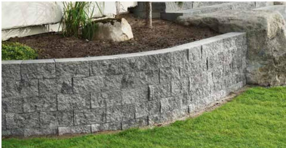
Glem ifylling av betong. Med Aneto støttemur er jobben gjort når blokkene er lagt. Muren har samme røffe utseende som forskalingsblokk med spitt, og kan bygges loddrett. En egen planen legges nederst og sikrer en jevn, plan start. Aneto er en komplett serie som også inneholder utvendige hjørner, kurvestein og toppstein.
