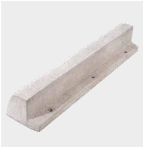
G stød er en praktisk og anvendelig kantstein som limes eller spikres fast på underlaget, for eksempel direkte på asfalt. Andre typer kantstein vil som regel settes først og deretter få asfalt eller annet belegg inntil.
