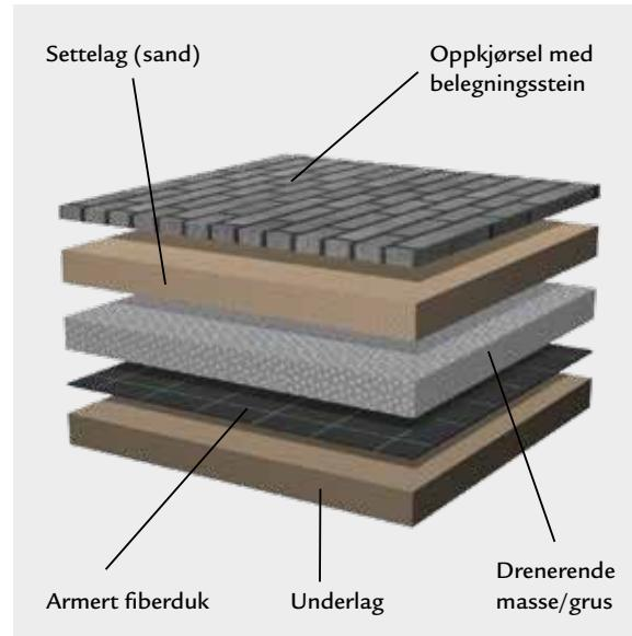
Denne armerte fiberduken hindrer at innkjørsler blir ødelagt av stygge hjulspor eller skjemmede sprekkar. Fiberduken legges enkelt under pukk og sand (duken må dekkes med pukk senest en måned etter installasjon). Den drenerer også bort vann og begrenser teleskader.
