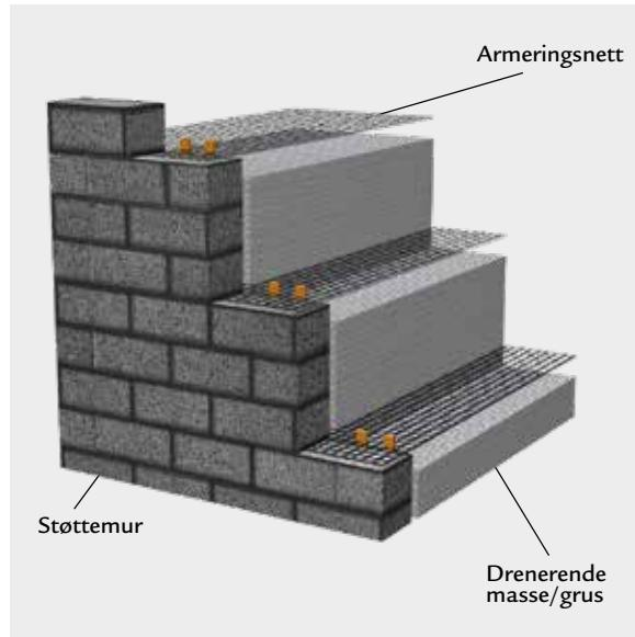
Planlegger du støttemur? Husk at jordmasser blir påvirket av varme, kulde, regn, grunnvann og tele. Armeringsnettet hindrer at muren blir ustabil og siger eller raser sammen. Nettet forankres i cirka hvert tredje lag med murblokker og plasseres minst én meter inn i massene bak muren.
