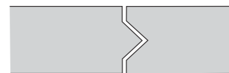
Not-fjær skaper forankring og en stødigere mur.
