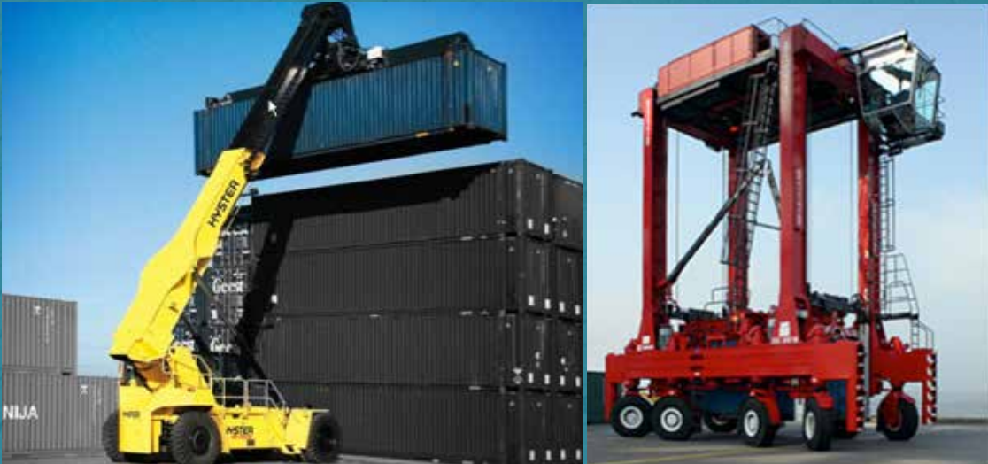
Fig. 3. Typer containerhåndteringsutstyr Reachstackere (venstre) og Straddle Carriers (høyre)
